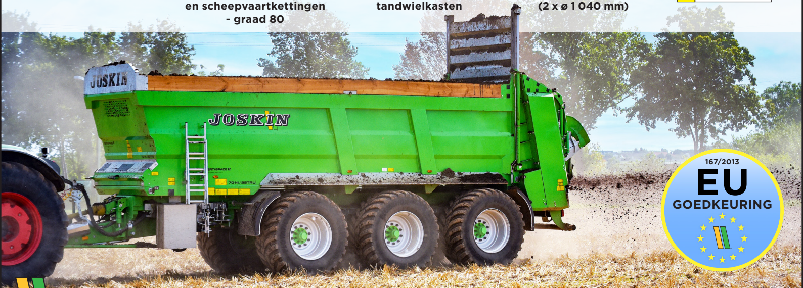
Hydraulische disselen en asvering
