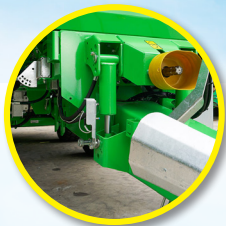
Hydraulische disselen en asvering
