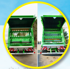
2 of 3 horizontale strooiwalsen met strooitafel (2 x ø 1 040 mm)
