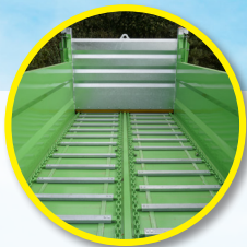
Dubbele bodemketting met vastgeboude latten en scheepvaartkettingen - graad 80
